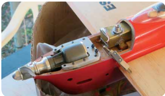
Sion hade byggt en Time Piece (om än lite modifierad) och försett den med en Parra T3 (=Oliver Tiger-kopia). Som Ni kan se av fotot är det en ren och fin installation under kåpan.
